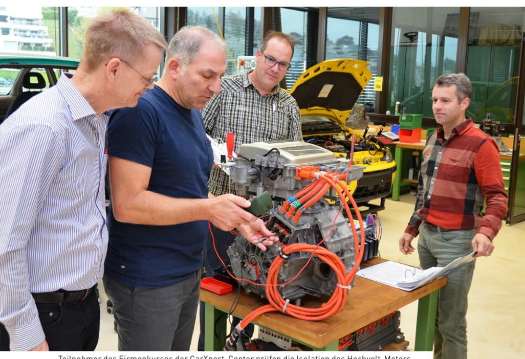
Teilnehmer des Firmenkurses der CarXpert-Center prüfen die Isolation des Hochvolt-Motors
